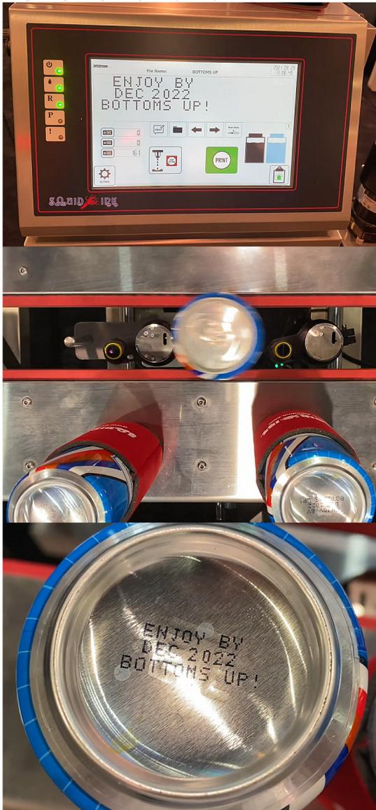
El CIJ JetStream Sonic de Squid Ink imprime caracteres pequeños en varios sustratos, como porosos y no porosos. Con una frecuencia de 94 kHz, es un 20% más rápido que el JetStream estándar (76.8 kHz) y viene con una boquilla de 50 micrones.
